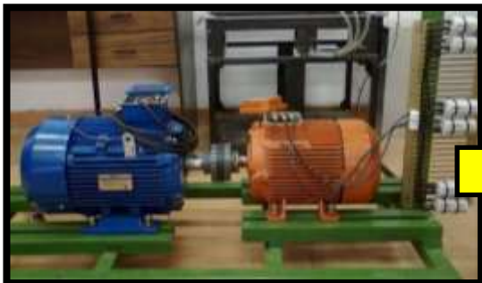
Motor + Generador (Microturbina + Generador)
