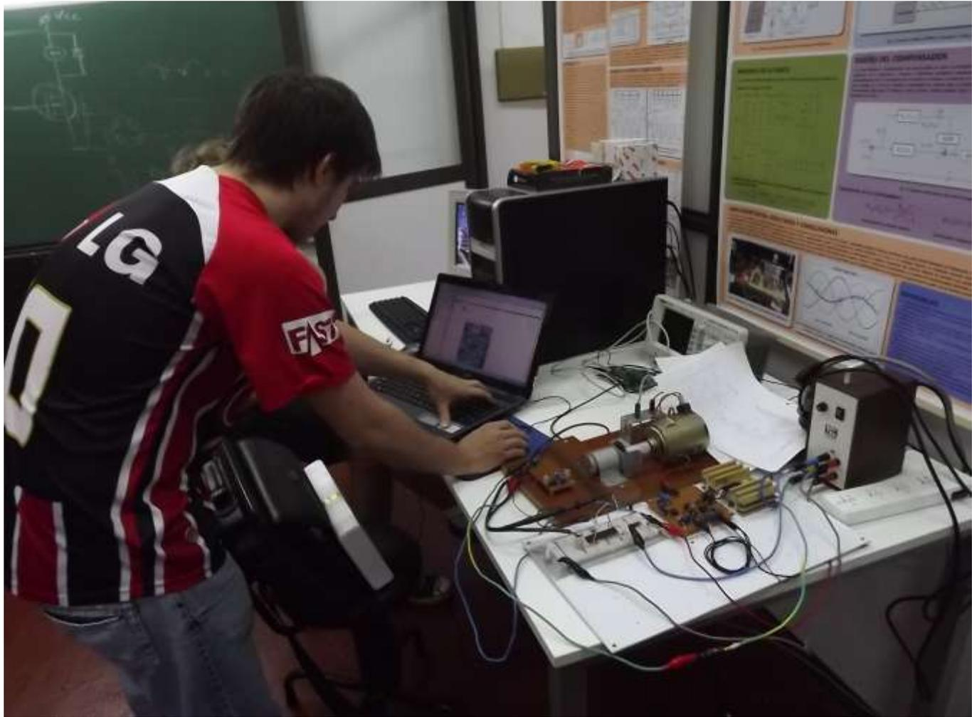
**Laboratorio Investigación y Desarrollo:** Alumnos verificando control digital de velocidad en motor de CC (ensayo de laboratorio para asignatura).
